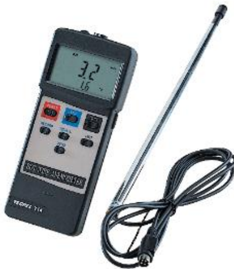
Figure 5.11. Tecpel AVM 714 Hot Wire Anemometer
