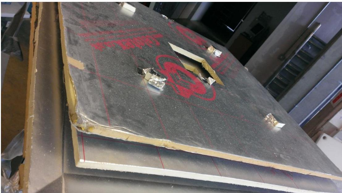
Figure 6.27 - Inert Celotex Diffuser
