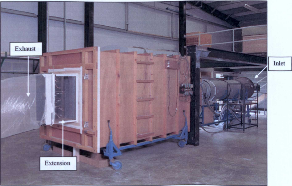
Figure 2.1: The fan test rig.
