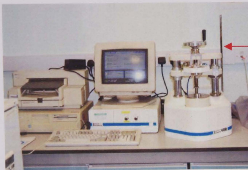
A.5 VOR rheometer and computer
